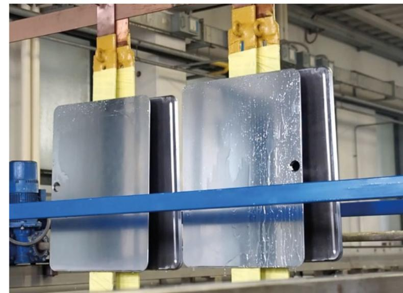
La cromatura a spessore, o cromatura dura, è un trattamento superficiale che deposita un rivestimento di cromo con uno spessore da 0,005 a 1 mm sui manufatti in leghe di alluminio e leghe metalliche standard (ferro, acciaio inox, rame, ottone).
