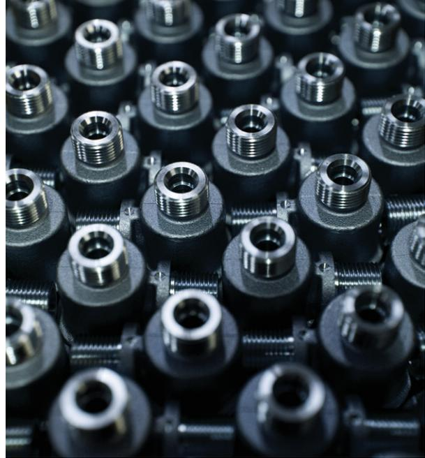
Il rivestimento TEA+ Ternary Eco Alloy Plus® viene generalmente applicato dopo il processo di depiombatura RUVECO® per ovviare al progressivo deterioramento dell'ottone che, nei componenti sottoposti a condizioni di lavoro estreme, come passaggio di vapore oltre i 100°C o frequenti cicli di decalcificazione, alimenta la circolazione del piombo nell'acqua o nei liquidi con cui entra in contatto.
